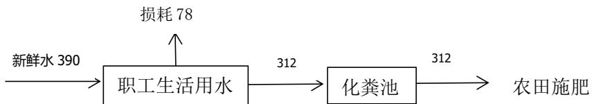
图 1 用水平衡图 (m<sup>3</sup>/a)
