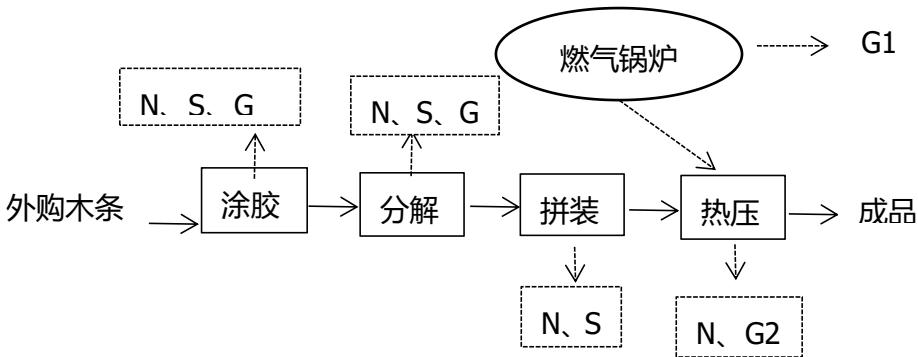
图 2 生产工艺流程及产污环节图
